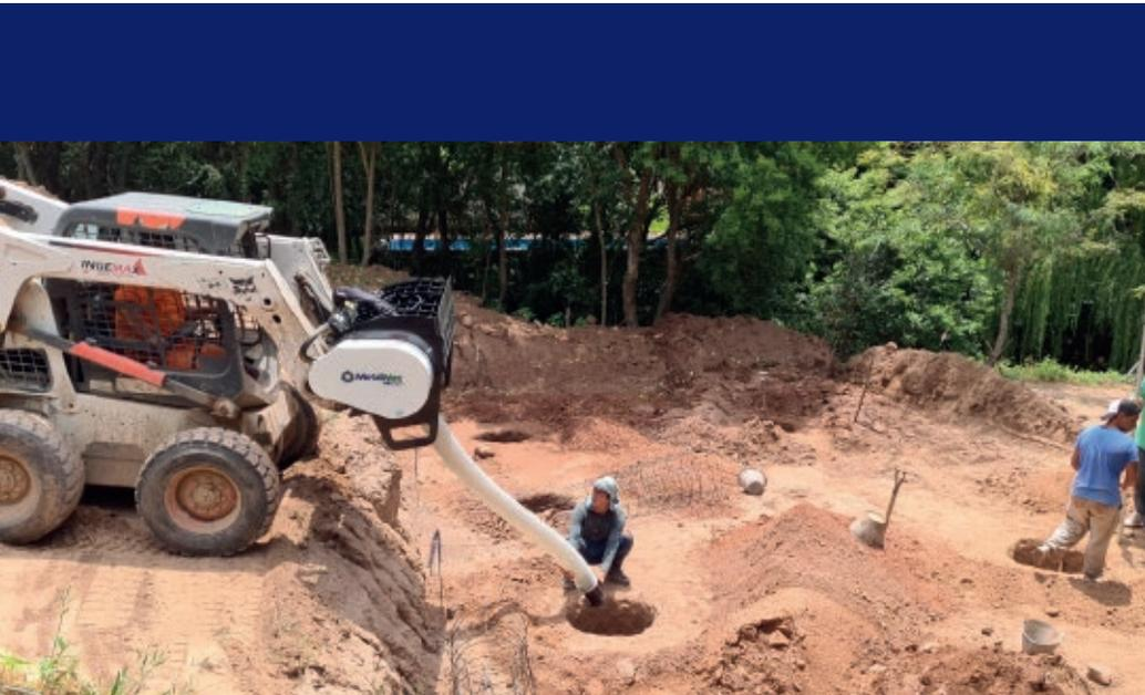
Con nuestro Balde Hormigonero convierte su minicargador en una mezcladora de hormigón eficiente con este accesorio resistente y rentable. El balde hormigonero BHM 300 de Metal-Mec le permite mezclar, transportar y descargar el hormigón mucho más rápido que un mezclador y una carretilla tradicional.
