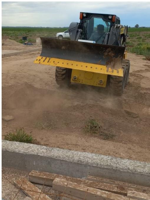
Nuestra Hoja Topadora es un implemento ideal para aplicaciones de construcción, donde su principio de funcionamiento consiste en desplazar tierra o material a mover mediante una cuchilla u hoja, solidaria a una mini cargadora, que es accionada por el empuje de ésta.
