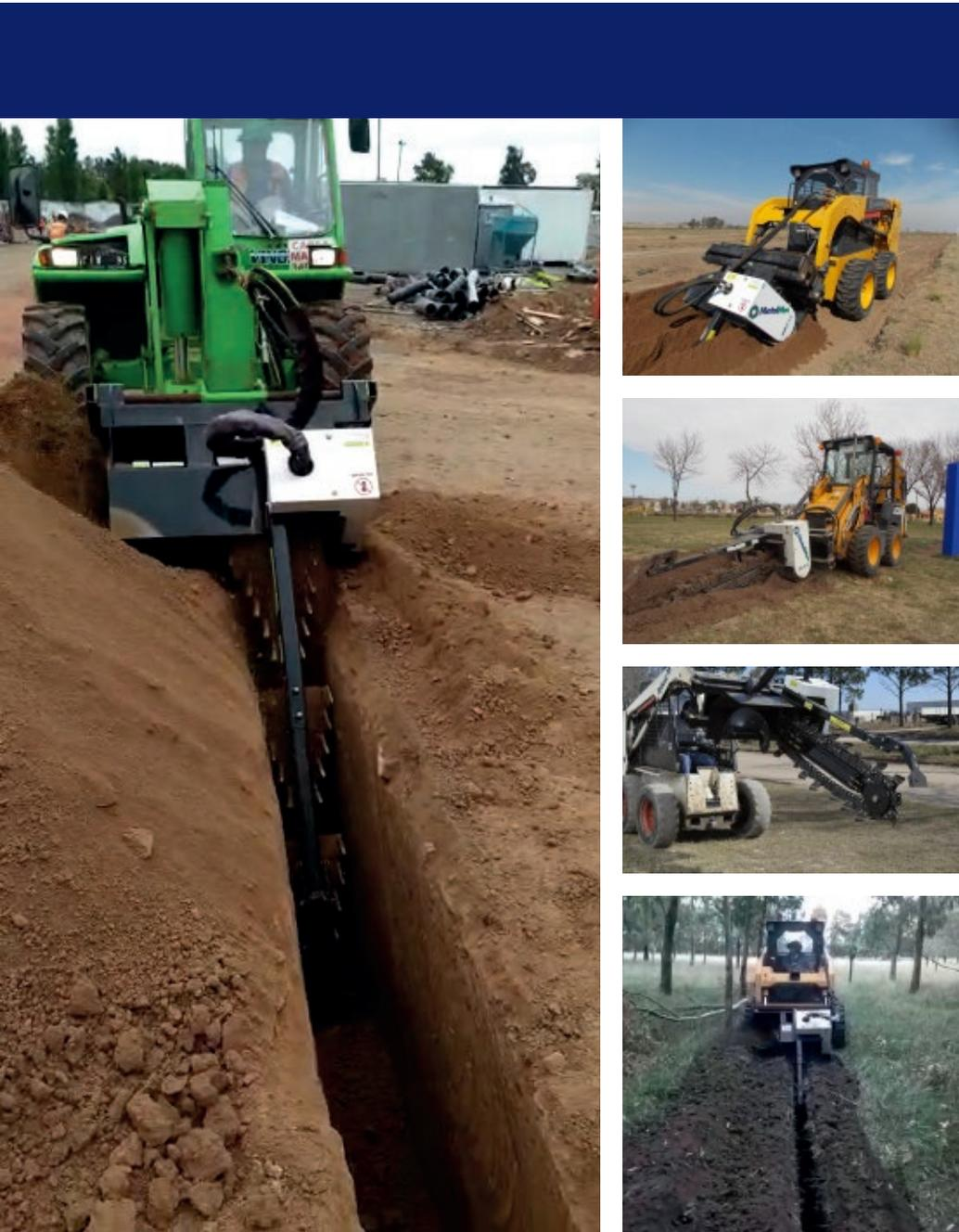
Nuestras Zanjadoras son las herramientas ideales para el realizado de zanjas, equipadas con motor hidráulico de alto torque y amortiguación de la puntera zanjadora, lo que permite un zanjeo suave. Transmisión por cadena con posibilidad de cambio manual de cuatro velocidades para obtener el mejor rendimiento al poder seleccionar mayor torque en suelos duros, o mayor velocidad en suelos blandos.
