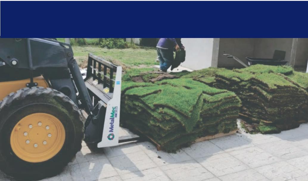
Con nuestro implemento Porta Pallets consiga que su minicargadora se transforme en un útil monta cargas. Cuenta con uñas certificadas que permiten el levantamiento de cargas de hasta 2.5 Tn.
