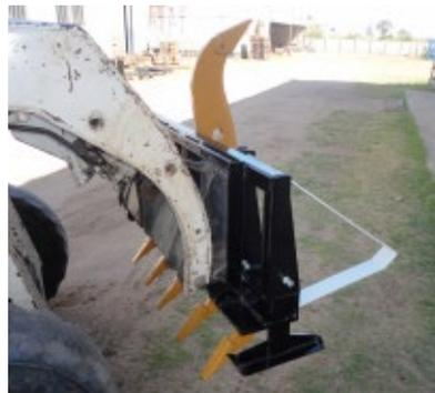
De diseño robusto y construido con materiales de primera calidad el Escarificador EM 5-1 como implemento, es una excelente herramienta para utilizar cuando la tierra esta endurecida o llena de raíces, permite descompactar el terreno antes de utilizar el balde, lo que se traduce en un menor desgaste del mismo y un significativo ahorro de combustible.
