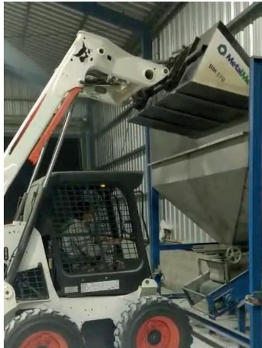
Nuestro Balde Cerealero es la herramienta ideal para aumentar el rendimiento de carga de su minicargador cuando necesita mover material de alto volumen y bajo peso. Posee una cuchilla de carga fundida en acero aleado lo que le asegura un mínimo desgaste.
