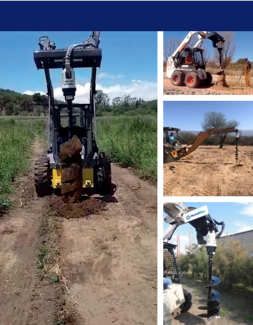
Nuestras Hoyadoras cuentan con transmisión por reducción planetaria de alto torque y mínimo mantenimiento.
