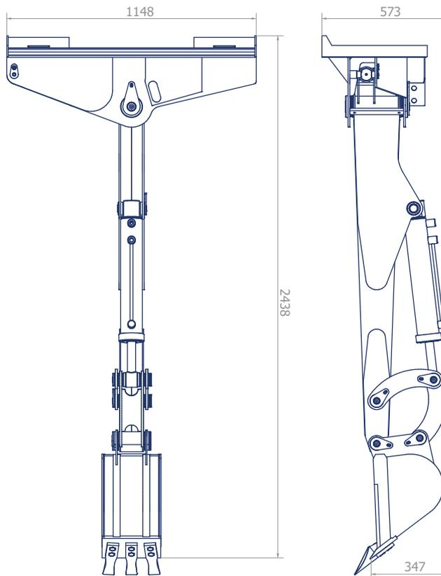
También podrá intercambiar baldes para variar el ancho de excavación a 250 mm, 350 mm y 450 mm. Usted podrá adquirir el Retroexcavador equipado con el balde que mejor se ajuste a sus necesidades y luego adquirir los demás baldes individualmente ya que son fácilmente intercambiables.
